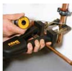
Radni kapacitet = kapacitet lemljenja = 2000 W!
