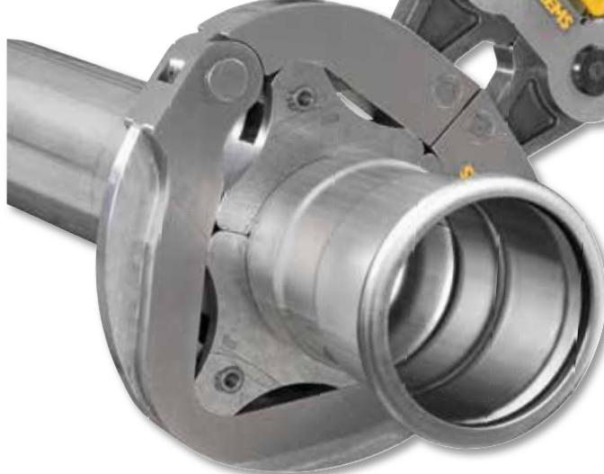
Na primer za sisteme spajanja krimpovanjem Geberit Mapress KARBONSKI ČELIK, NERĐAJUĆI ČELIK, BAKAR u instalacijama pitke vode i grejanja do Ø 108 mm.
